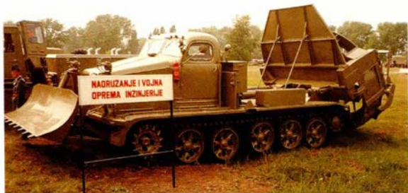
MDK-2M, graafmachine met dozer
